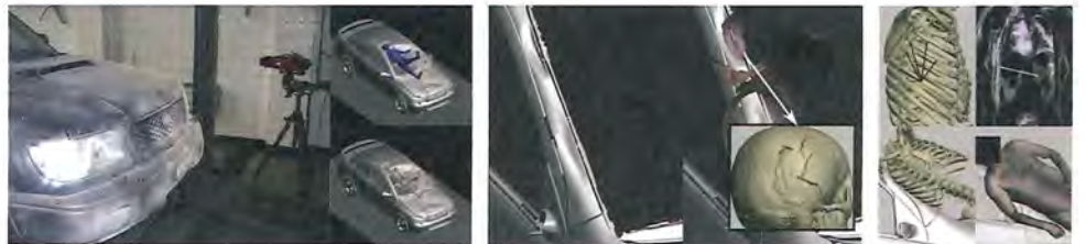
④人体とインタラクションする物体(ここでは車)に関してもスキャンを行い、②の方法で復元された人体と組み合わせることによって、人体と物体とのインタラクションを正確にシミュレーションすることができる(ここでは自動車事故による人体の損傷)
