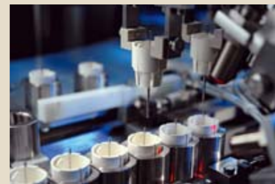
Beim dargestellten Montagesystem für einen Mehrfach-Flüssigkeitsinhalator ohne Treibgas liegt der Fokus auf Gesamteffizienz Bild: Sortimat
