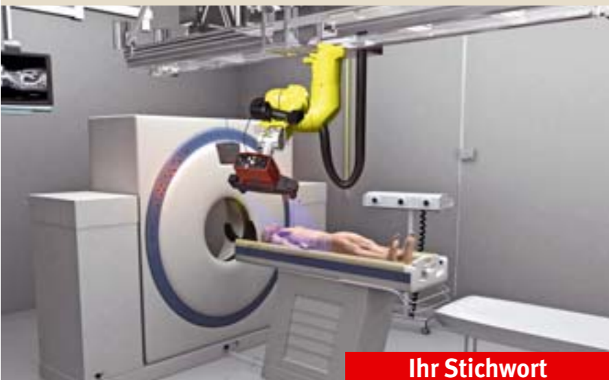
Erst die Lichtstreifen, dann der Scan: Im Virtopsy-Labor wird die Körperoberfläche erfasst. Der Roboter, der das leistet, stammt aus der Industrie und bewegt sich an einer Schiene, die an der Decke montiert ist. Bild: IRM, Uni Bern
